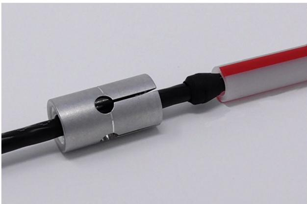
3.2 Dichtung auf das Kabel fädeln und bis zum Anschlag in das Mikrorohr schieben. WGT Gehäuse ebenfalls auffädeln.
